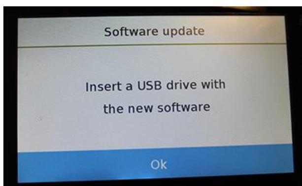
在将 U 盘插入天平左侧接口之前，检查 U 盘是否加载了 AE Adam 提供的升级程序，并按 **"Ok"** 键确认。
