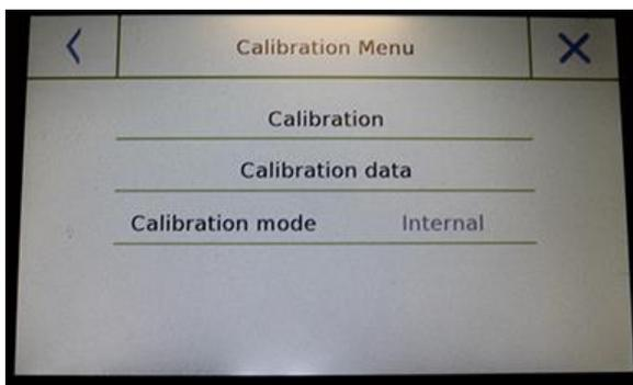
在校准菜单中，你可以校准、显示并打印最后校准数据并设置校准模式。
