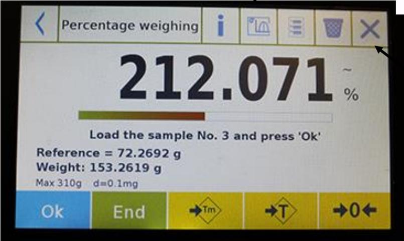
点击“OK”键获取一个新重量并点击“结束”键结束获取并执行最终的统计计算。
