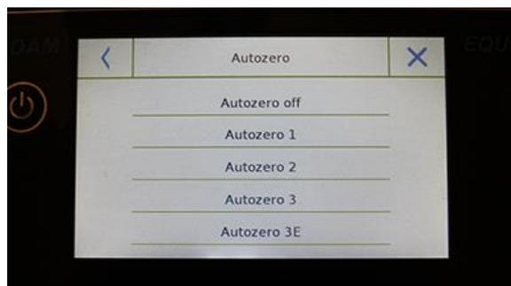
**自动回零:** 自动回零不断调整显示为零的重量值。变化可能是由沉积在称量板上的污垢、水分或灰尘引起的。您可以通过选择**"Off"** 模式禁用此功能。
