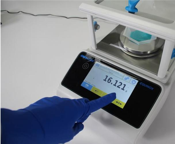
进入称量界面时，显示重量的区域显示天平称量板/秤盘上的重量值。
