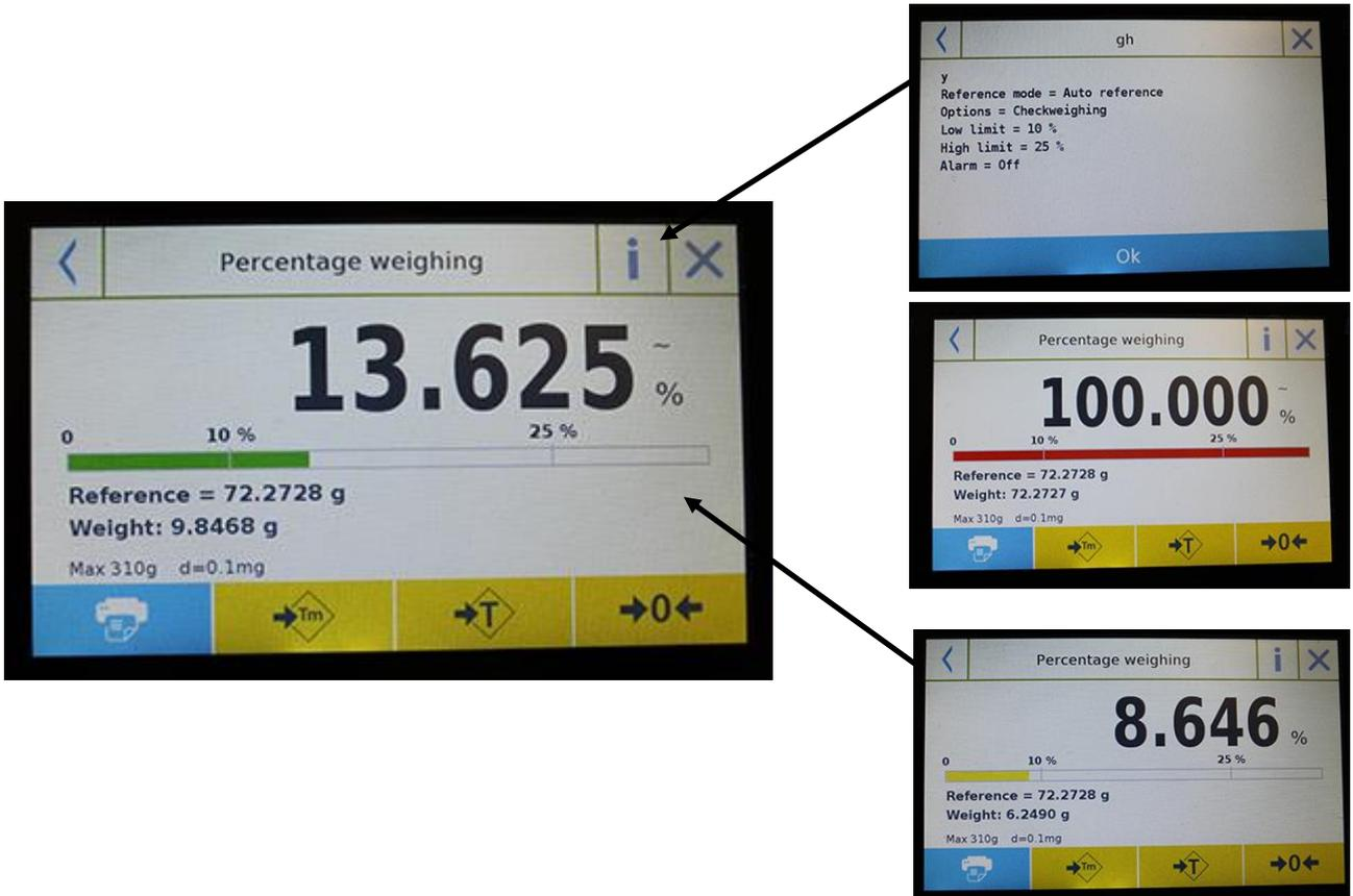
当加载的重量低于下限时，检重条为黄色，当重量在设定的范围内时（激活时有提示音），检重条为绿色，当重量高于上限时，检重条为红色。
