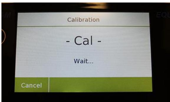
加载所需的校准重量或点击"取消" 键取消校准流程。
