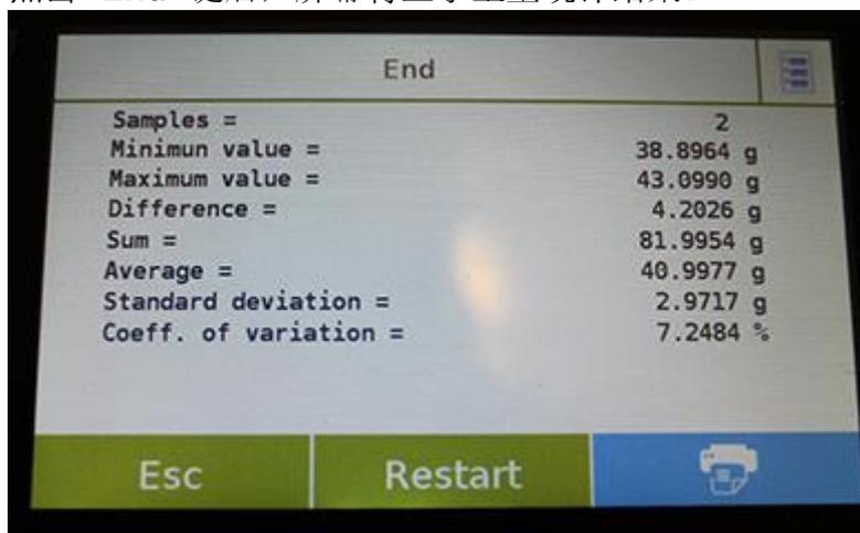
点击 "Esc" 键退出此功能，点击 "Restart" 键进行新的测量，点击 "Print" 键打印测量结果。
