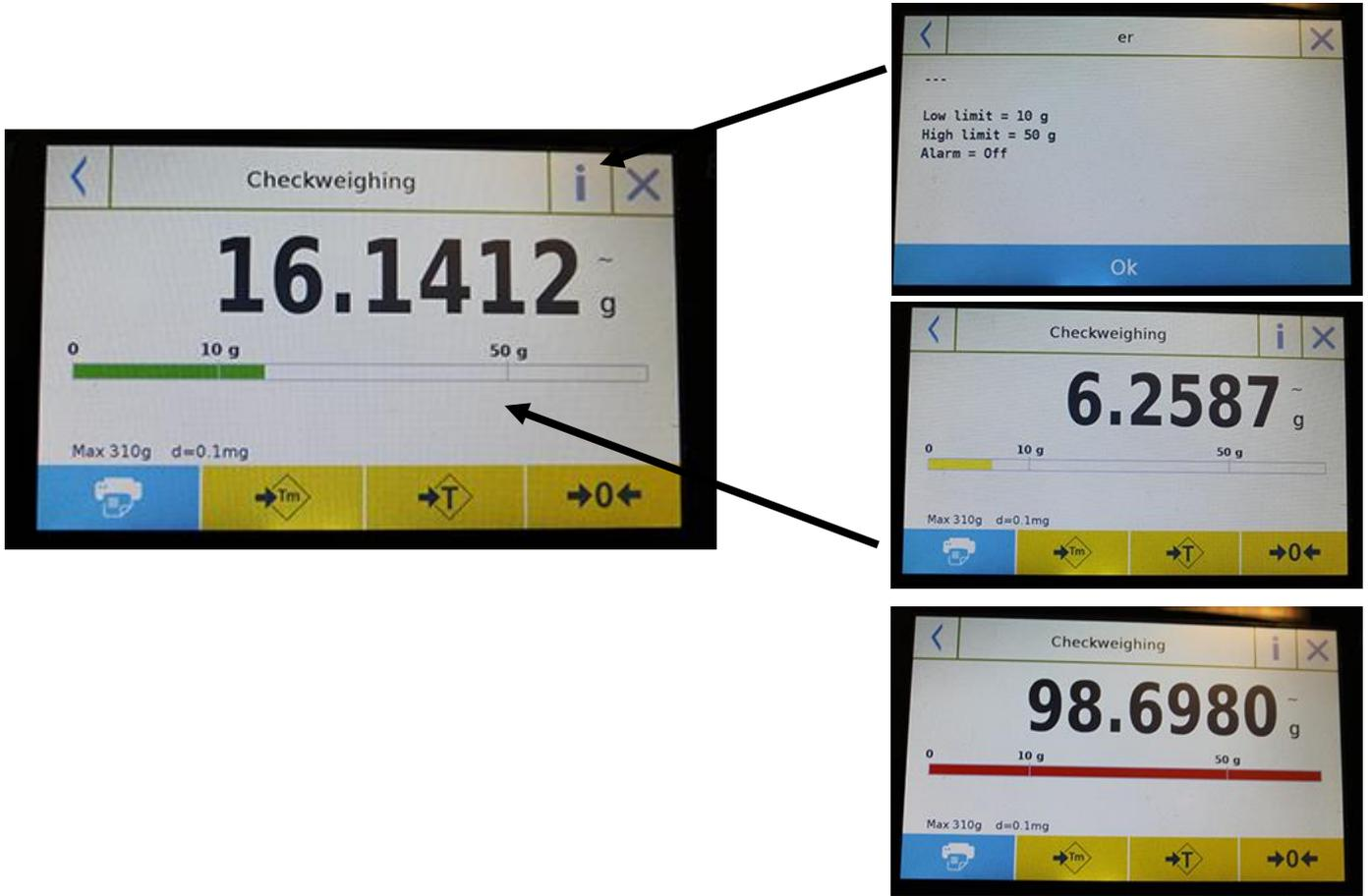
当加载的重量低于下限时，检重条为黄色，当重量在设定的范围内时（激活时有提示音），检重条为绿色，当重量高于上限时，检重条为红色。
