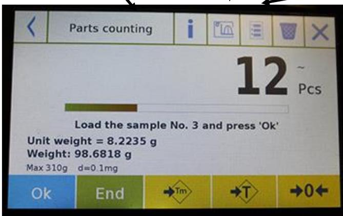
点击 "OK" 键获得一个新的重量并点击“结束”键结束捕获并执行最终的统计计算。
