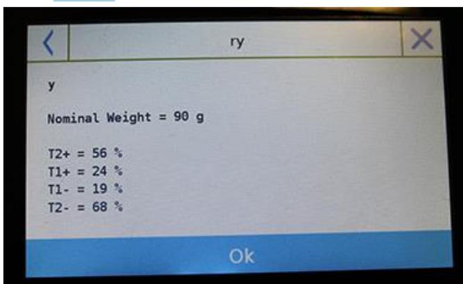
点击 "End" 键后屏幕将显示称重统计的结果。
