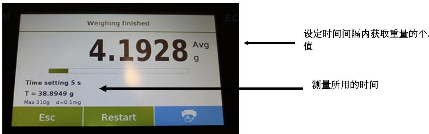
点击 "Esc" 键退出此功能，点击 "Restart" 键进行新的测量，点击 "Print" 键打印测量结果。
