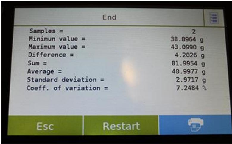
点击 "**Esc**" 键退出此功能，点击"**重启**"键 进行新的测量，点击 "**打印**" 键打印测量结果。
