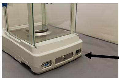
3) 然后将电源适配器连接天平附近的电源插座。不要使用不符合规格的线束/扩展线。
