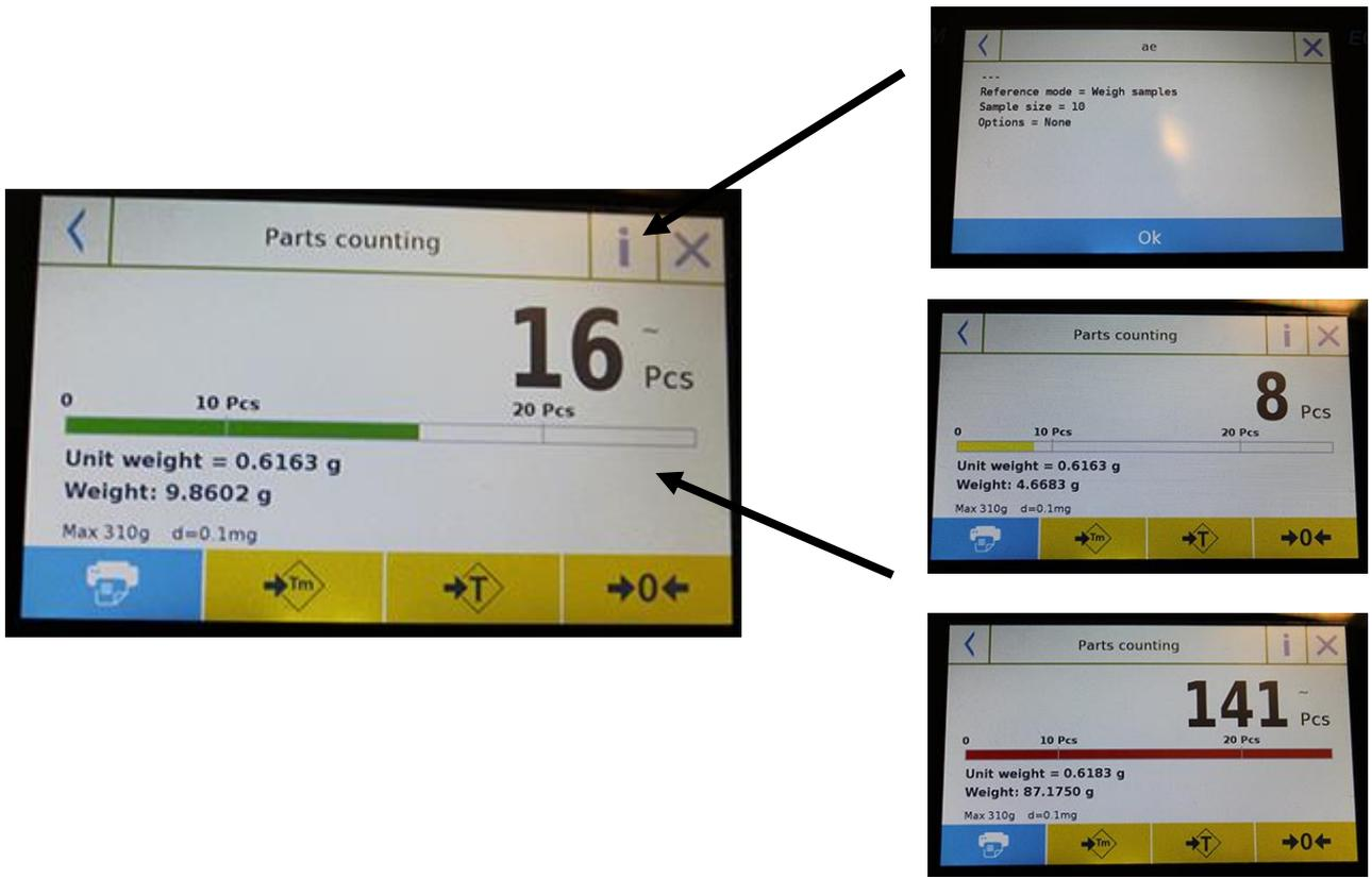
当加载的零件数量低于下限时，零件数量控制条是黄色的。当零件数量在设定的范围内时（激活时，有提示音），控制条是绿色的，零件数量超过上限时，控制条是红色的。
