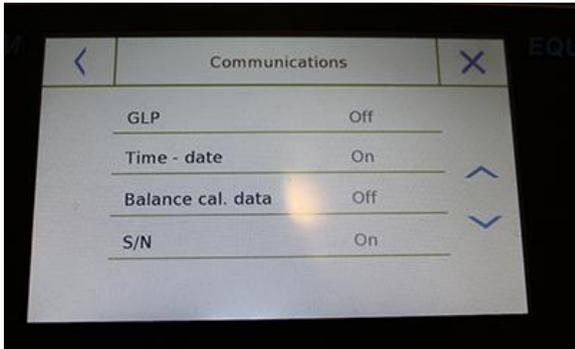
在"通信" 菜单界面，您可以立即检查参数设置值（在参数右侧的方框中）
